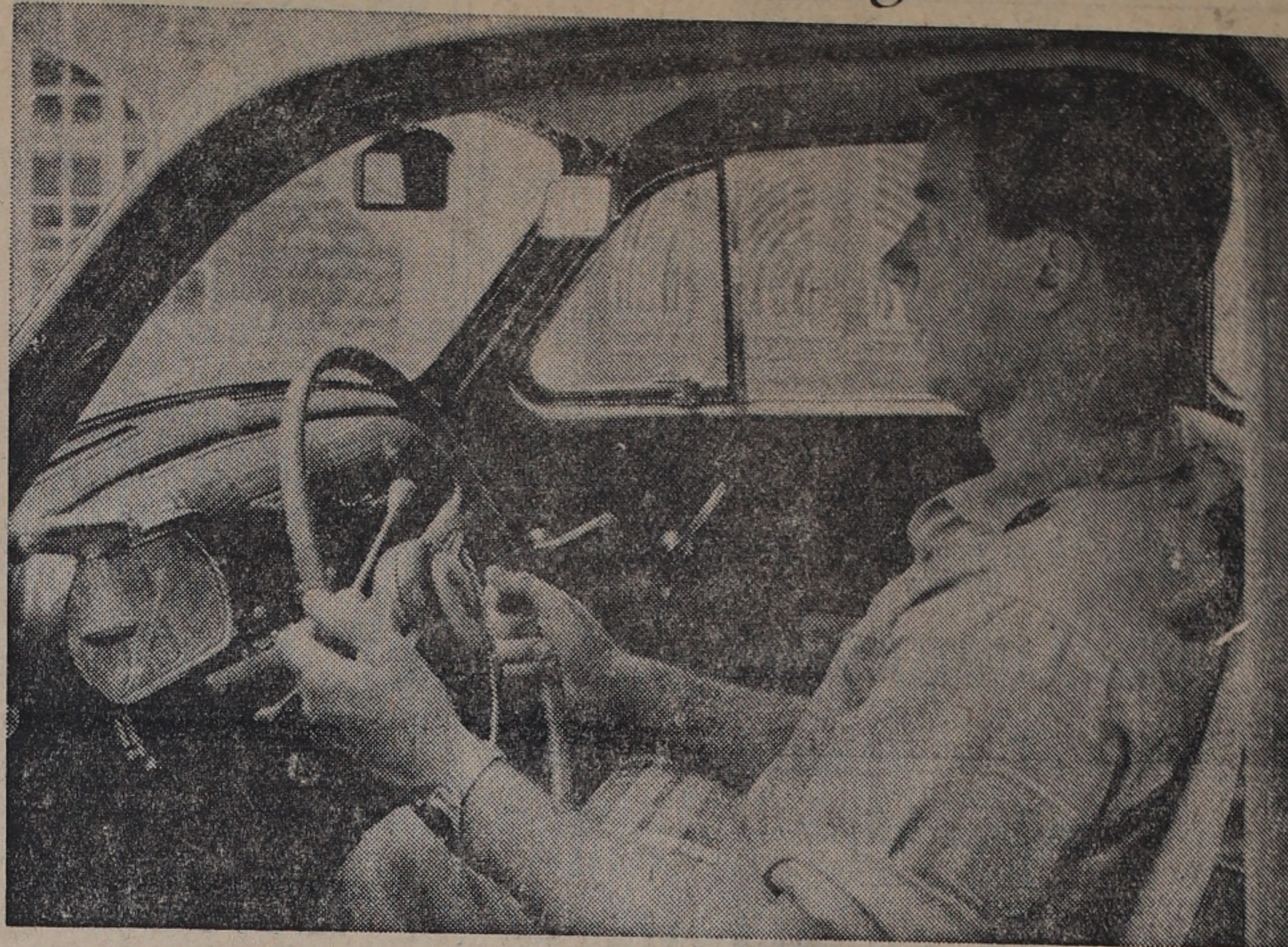
Omkörningsspeglarna till höger i vindrutans övre hörn ger högersikt vid omkörning även för vänsterstyrda bilar.
