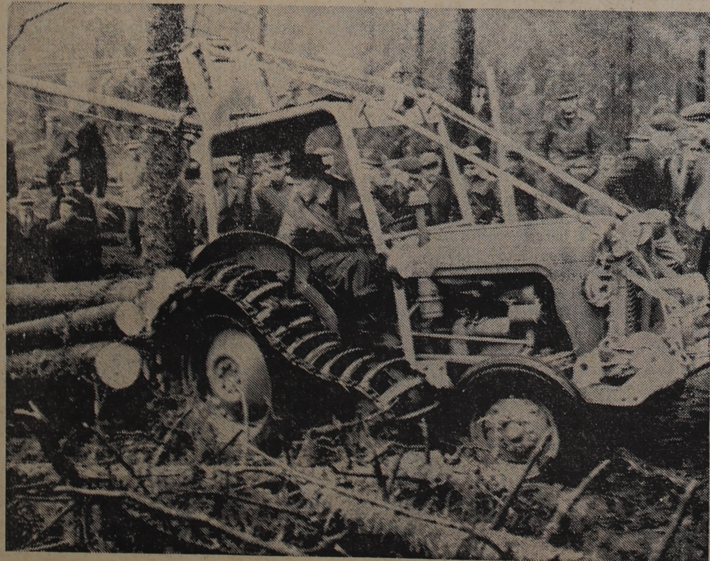
Den lilla traktormodellen försedd med halvband och frontmonterad vinsch ökar användningstiden i skogen.
