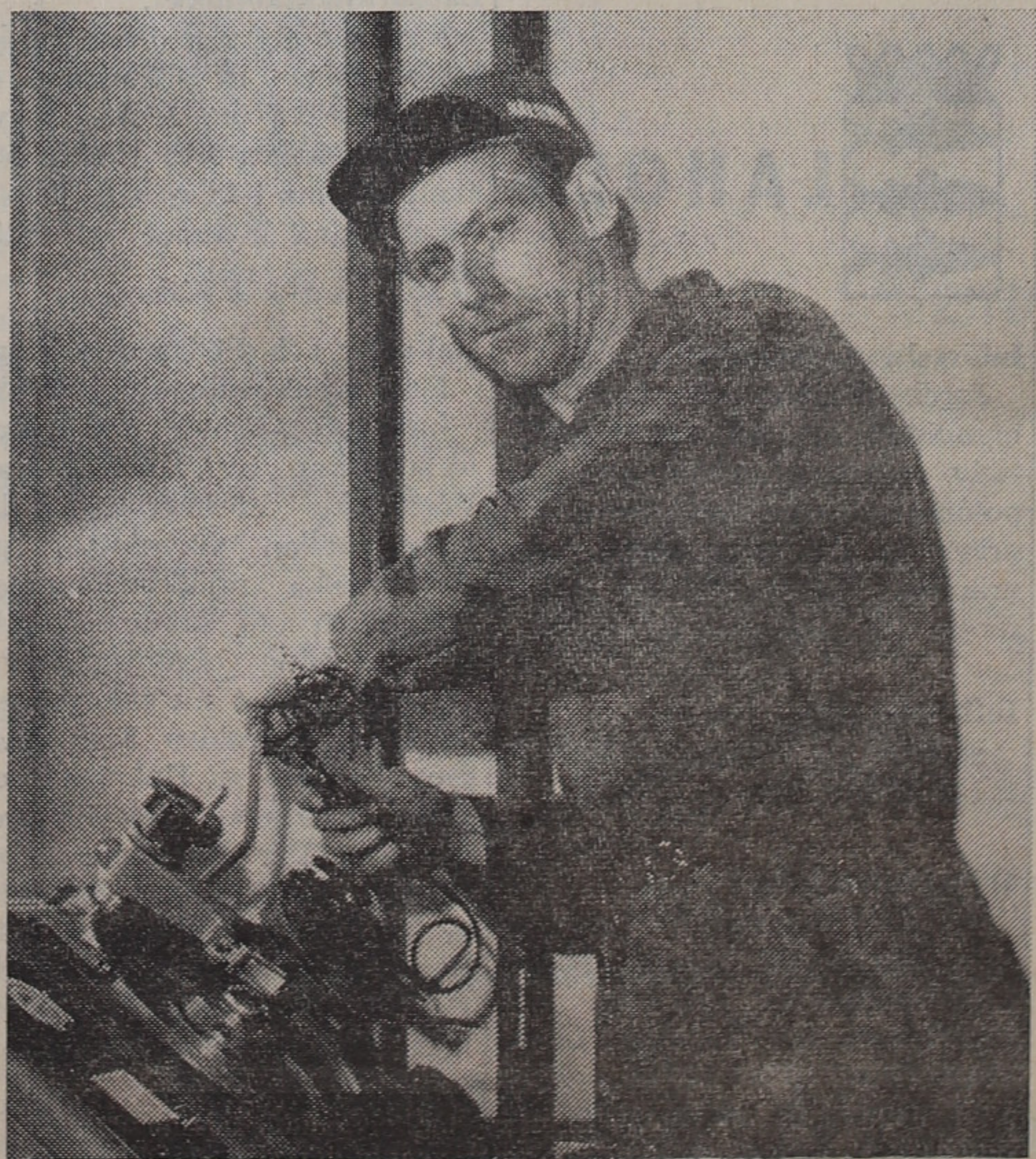
Erik Svensson kommer själv att ta hand om alla bilelektriska reparationer och mätningar. Här ses han vid en s. k. strömfördelarbänk
