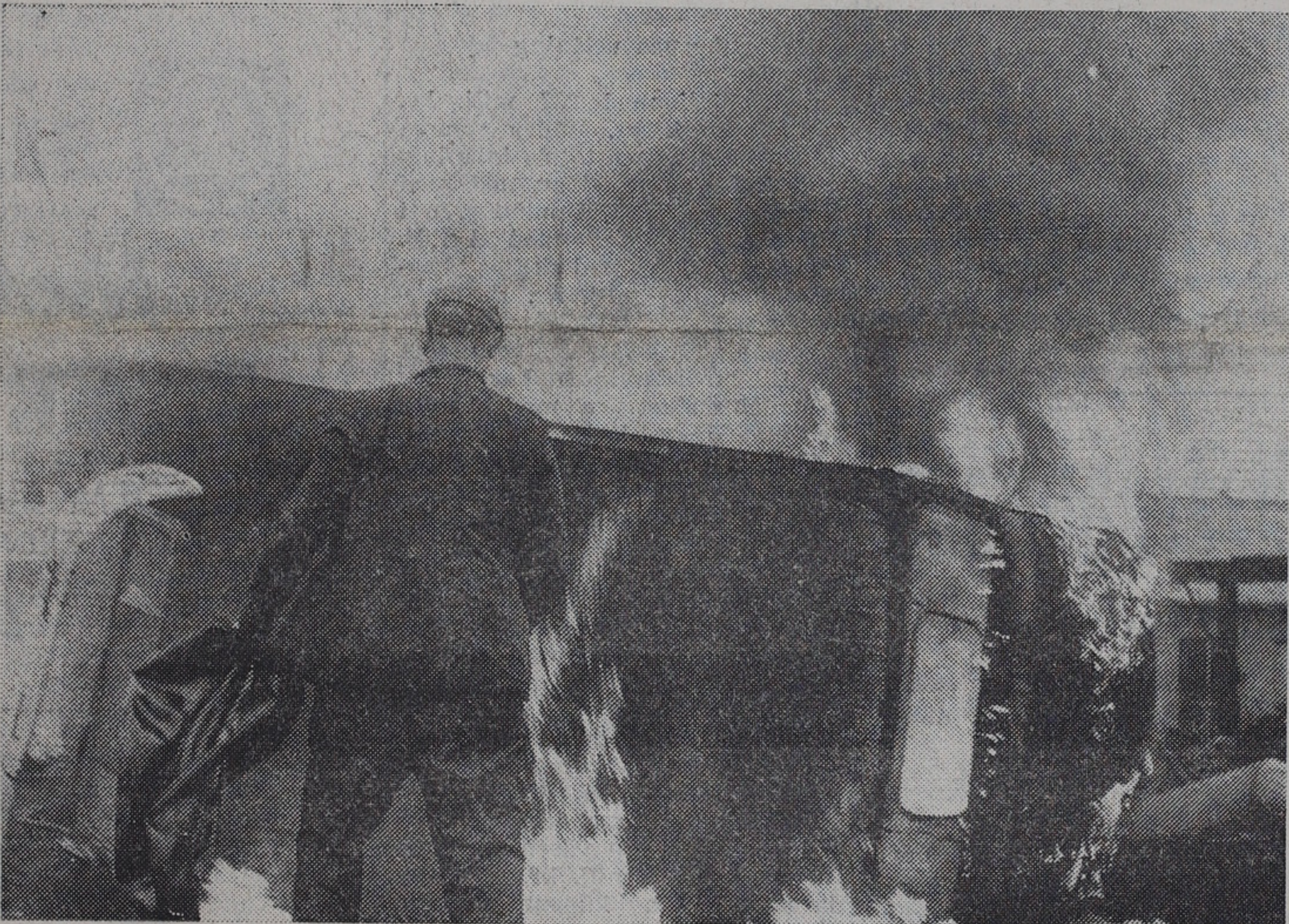
Allt, som är brännbart, måste bort innan pressen kan ta hand om det som en gång var en paketlastbil. Med hjälp av olja och gamla gummislangar fick man en så intensiv hetta, att det snart bara återstod plåten.
