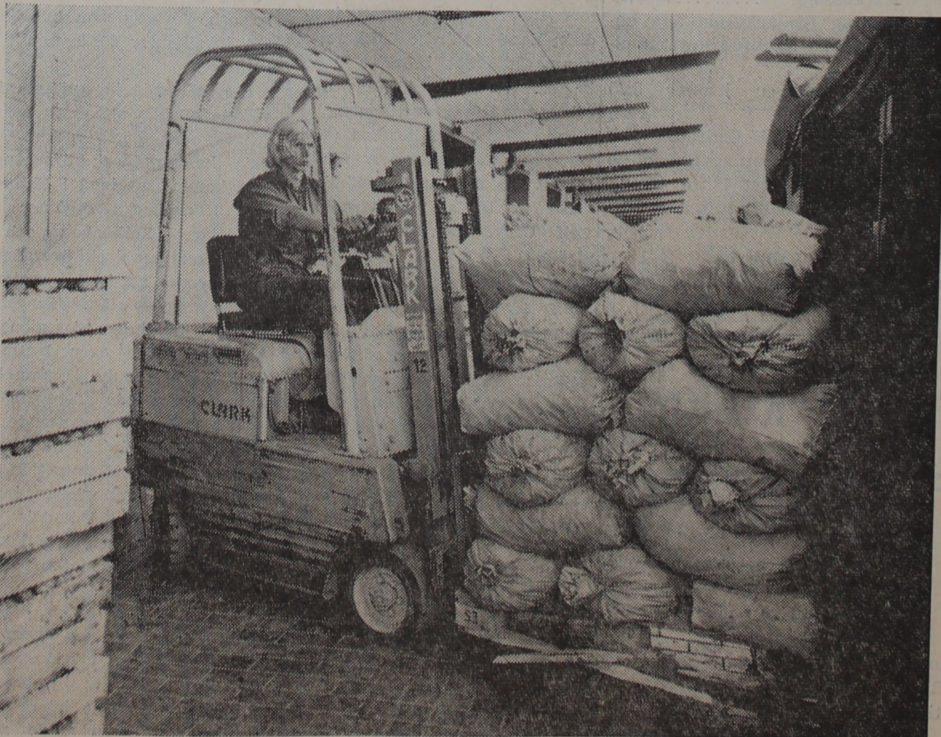
Papperssäckens format är avpassat för standardlastpallen, varför den lämpar sig mycket väl för pallhantering. Risken för förskjutning i pallast är minimal, eftersom de olika säcklagren binder varandra.
